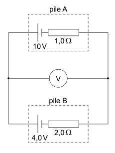
La pile A a une f.é.m. de 10 V et une résistance interne de 1,0  $\Omega$ . La pile B a une f.é.m. de 4,0 V et une résistance interne de 2,0  $\Omega$ .
