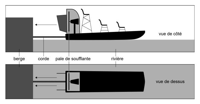
Un hydroglisseur a une pale de soufflante d'un rayon de 1,8 m. Cette soufflante peut propulser de l'air avec une vitesse maximum de 20 m s<sup>-1</sup> par rapport à l'hydroglisseur. La densité de l'air est 1,2 kg m<sup>-3</sup>.
